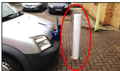
Poste de 1m de comprimento na frente de uma câmera montada a 0,6m
